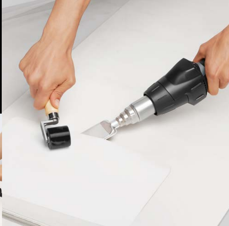
▲ Saldatura di teloni HG 2220 E
